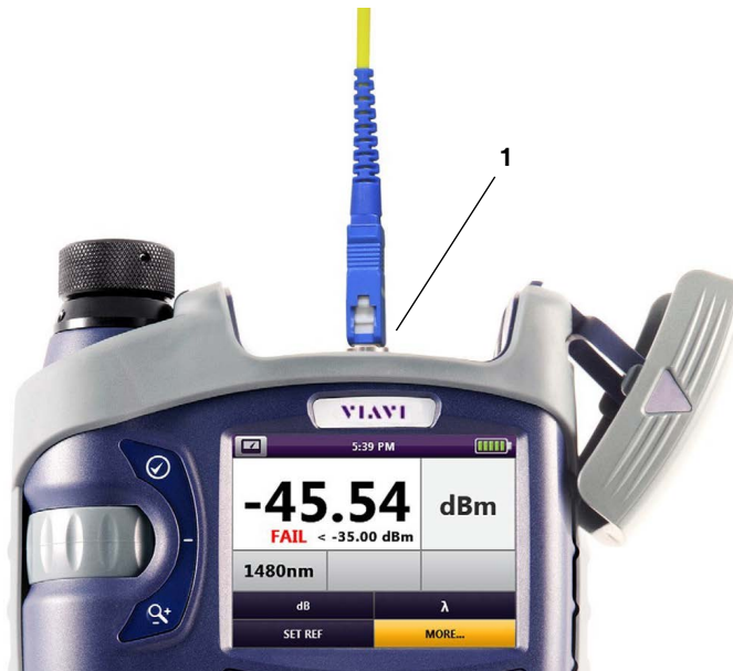
Fig. 20: UPP Power Meter Input
